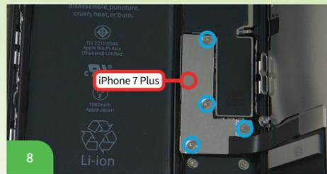
**DE** Befestige die Metallabdeckung des Konnektors mit **diesen Schrauben**.
