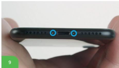
**DE** Drücke das Display wieder in den Gehäuserahmen und befestige das Ganze mit **den zwei Pentalobe-Schrauben**.
