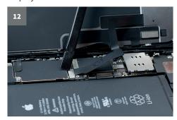
Entferne anschließend den Stecker des Displaykabels mit der Spitze Deines Spudgers.
