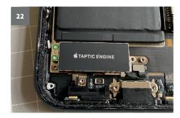
Die Taptic Engine ist mit zwei Kreuzschlitz-Schrauben links befestigt. Löse diese und lege sie beiseite.
