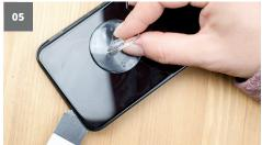
⚠ Hier mußt Du Geduld besitzen, um die Clips nicht zu beschädigen. Ausserdem solltest Du das Hebewerkzeug nur wenige Millimeter ins Gehäuse einführen, da du sonst die Sensoren am oberen Ende des Displays beschädigen könntest.
