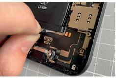
Sobald der Klebestreifen gelöst ist, kannst Du ihn mit zwei Fingern packen und unter dem Akku hervorziehen. Du musst den Klebestreifen nicht für den Wiedereinbau aufheben. Wir haben Dir neue Streifen für Deinen Fixxoo Akku eingepackt.
