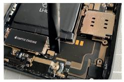
Löse nun den Stecker der Taptic Engine mit dem Spudger.
