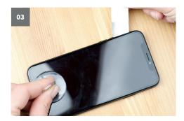
$\triangle$  Schiebe das Hebewerkzeug nicht zu tief in das iPhone hinein, da Du sonst unter Umständen Bauteile im Inneren beschädigst.
