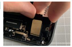
**Entfernen der Taptic Engine**
