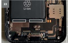
Am unteren und oberen Rand (nicht abgebildet) des Akkus sind je 2 Klebestreifen angebracht. Diese halten den Akku fest in seiner Position.
