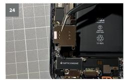
Nun ist der Sim-Kartenleser frei und kann mit der Pinzette aus dem Gehäuse gehoben werden.
