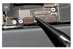
Darunter wird der Weg zum Stecker des Touchscreen-Kabels frei. Auch dieser wird entfernt.
