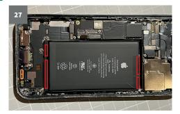
Auf jeder Seite des Akkus befinden sich zwei Klebestreifen, die Du ablöst und langsam unter dem Akku hervorziehst. Beginne am unteren Ende.
