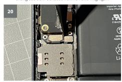
Darunter befindet sich der Stecker des Sim-Kartenlesers, den du mit dem Spudger aushebelst.
