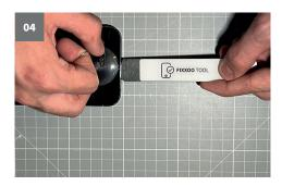
⚠ Schiebe das Hebewerkzeug nicht zu tief in das iPhone hinein, da Du sonst unter Umständen Bauteile im Inneren beschädigst.
