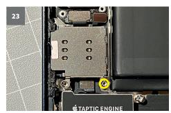
Dadurch wird eine weitere Schraube sichtbar, diesmal eine Abstands-Schraube (Standoff). Löse diese ebenfalls.
