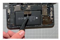
Anschliessend kannst Du die Abdeckung mit der Pinzette entnehmen.
