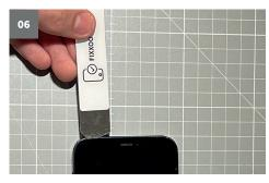
Durchtrenne den restlichen Kleber am oberen Rahmen, indem Du das Hebewerkzeug nach links schiebst.
