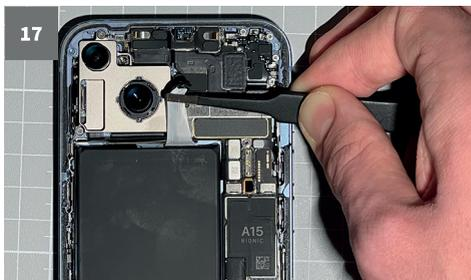
**⚠ Falls einer der Klebestreifen reißt: Bitte reagiere nicht mit Gewalt. Der Akku darf nicht gequetscht oder gebogen werden. Oft hilft schon etwas Lösungsmittel, das Du unter den Akku träufelst oder ein Erhitzen mit dem Fön.**
