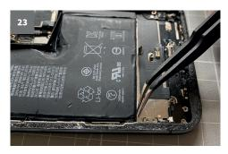
Löse die Klebestreifen mit der Pinzette ab. Du erhältst von uns Ersatzklebestreifen für deinen neuen Akkusei trotzdem vorsichtig und beschädige nicht den alten Akku.
