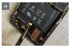
Mit dem Spudger kannst Du den Lautsprecherstecker aus dem Gehäuse lösen.
