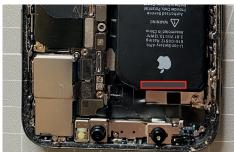
Der Akku ist mir Klebestreifen am Gehäuse befestigt.
