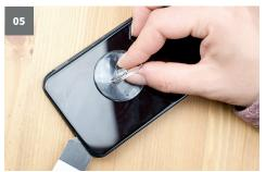
Durchtrenne den restlichen Kleber am oberen Rahmen, indem Du das Hebewerkzeug nach links schiebst.
