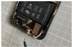
Entferne nun die Schraube, mit der die Abdeckung des Lautsprechersteckers befestigt ist und hebe anschliessend die Abdeckung mit der Pinzette aus dem Gehäuse.
