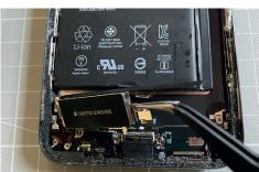
Nun kannst Du die Taptic Engine aus dem Gehäuse entfernen.
