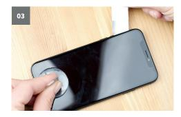
△ Schiebe das Hebewerkzeug nicht zu tief in das iPhone hinein, da Du sonst unter Umständen Bauteile im Inneren beschädigst.
