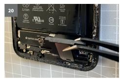
Anschliessend kannst Du den Lautsprecher mit der Pinzette aus dem Gehäuse heben.
