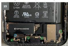
Entferne anschliessend die beiden Halterungen mit der Pinzette und lege sie zur Seite.
