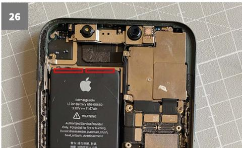
Am Akku befinden sich jeweils seitlich fünf Klebestreifen. Diese fixieren den Akku innerhalb des Gehäuses.
