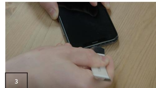
**Germany** Fahre mit dem Metallspatel auch auf der anderen Seite vorsichtig entlang, um das Display komplett vom Rahmen zu lösen. Auch hier ist Vorsicht geboten, da sonst die Sensoren an der Oberseite des iPhone beschädigt werden können.
