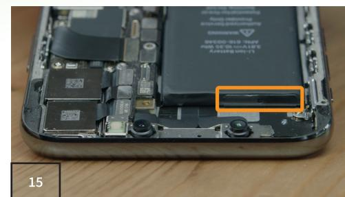
Germany: Der letzte Klebestreifen ist in der Nähe des FacID-Sensors. Achte darauf, den Sensor nicht zu beschädigen, da sonst FacID auf deinem iPhone X nicht mehr funktioniert.
