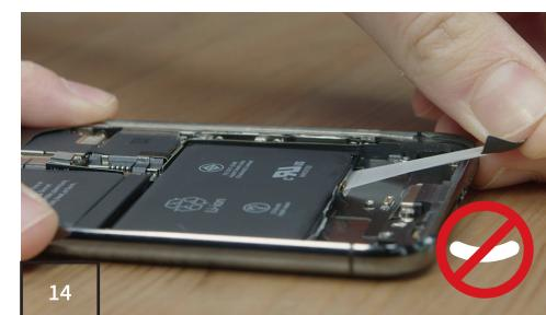
Germany: Ziehe vorsichtig an den schwarzen Enden der Klebestreifen. Ziehe sie ganz langsam und gleichmäßig in einem Winkel von etwa 30° unter dem Akku hervor. Die Klebestreifen werden sich stark dehnen. Wenn nötig, kannst Du einfach nachfassen und nahe des Akkus neu ansetzen.
