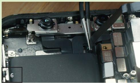
■ Löse vorsichtig das verklebte Flachkabel aus dem Rahmen. Löse den Kleber vollständig aus dem Rahmen, mit dem das Display gehalten wird.
