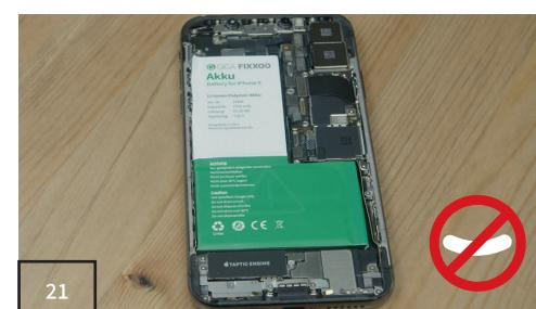
■ Beseitige alle Kleberreste aus dem inneren des Gehäuses und befestige den neuen Akku mit etwas doppelseitigem Klebeband im Rahmen.
