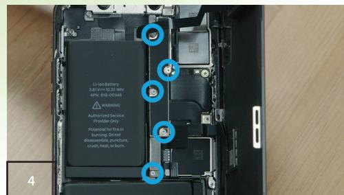
**Germany** Klapp die Display auf wie ein Buch und löse **diese Schrauben** der Metallabdeckung. Lehne das Display gegen die Verpackung des iPhone oder ein Buch als Halterung. Merke Dir genau, welche Schraube wohin gehört!
