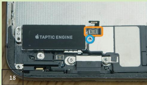
■ Befestige den Konnektor des Lautsprechers und die Metallabdeckung des Lautsprecher-Konnektors wieder mit einer Schraube.
