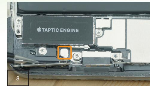
■ ■ Hebe die Metallklammer vorsichtig ein wenig an, sie ist noch mit einem Flexkabel mit dem Gerät verbunden. Löse **den kleinen Konnektor** unter der Metallklammer vorsichtig mit dem spitzen Ende des Plastikspatels. Entferne dann auch die Metallklammer.
