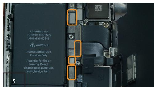
**Germany** Löse **diese Konnektoren** vorsichtig mit dem flachen Ende des Plastikspatels. Zuerst den Akku-Konnektor, dann die übrigen.
