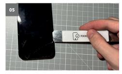
Durchtrenne den restlichen Kleber am oberen Rahmen, indem Du das Hebewerkzeug nach links schiebst.
