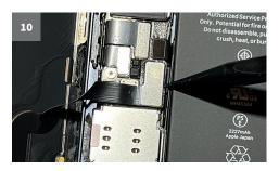
Direkt unter dem nun entfernten Akkustecker sitzt der OLED-Displaystecker, den du als nächstes entfernst.
