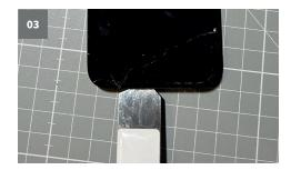
△ Schiebe das Hebewerkzeug nicht zu tief in das iPhone hinein, da Du sonst unter Umständen Bauteile im Inneren beschädigst.
