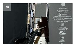
Anschliessend kannst Du die Abdeckung mit der Pinzette entnehmen.
