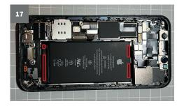
Auf jeder Seite des Akkus befinden sich zwei Klebestreifen, die Du ablöst und langsam unter dem Akku hervorziehst. Beginne am unteren Ende.
