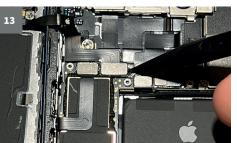
Nun ist noch der Stecker der Frontsensoreinheit frei, den Du in gleicher Weise löst.
